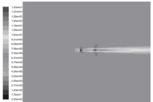
图10 12 m/s 圆柱形换能器速度云图
