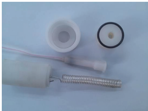
图2 余氯传感器内部结构图
