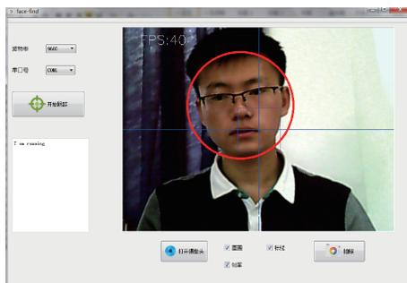
图 6 系统运行截图。圆圈表示检测到的人脸位置,方框内两直线相交点表示视频的中心
