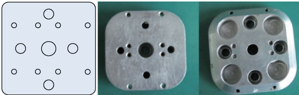
图 3 新台面设计图及台面正、反面实物
