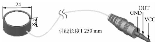
图3 华科压电式脉搏波传感器
