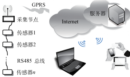
图 1 智能测斜系统构成示意图
