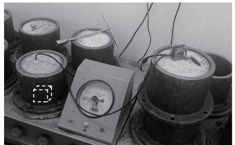
图5 测斜传感模块(虚线标出)防水试验装置
