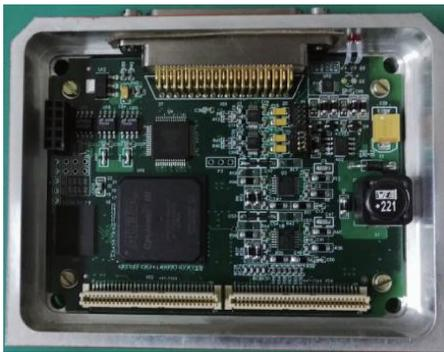
图 6 振动信号采集卡实物
