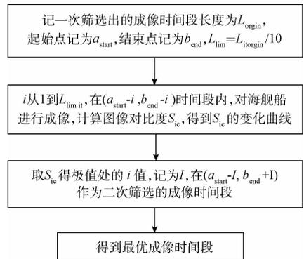
图 4 利用图像对比度的二次筛选算法流程
