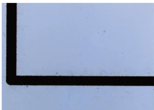
图12 L型硅基微通道的表面形貌
