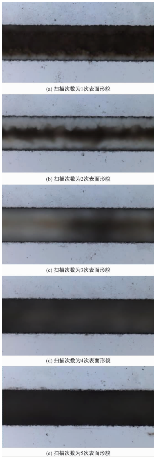
图 8 不同扫描次数下刻蚀硅基微通道的表面形貌
