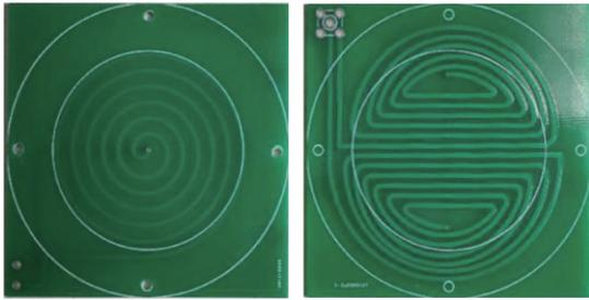
图 7 螺旋线圈和蝶形线圈
