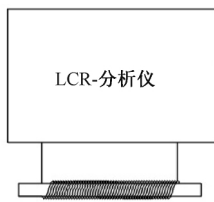
图 2 天线的电阻、电容和电感测量
