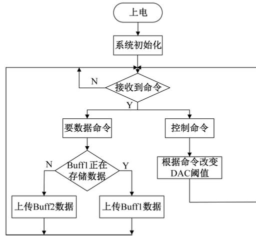
图 6 主程序流程
