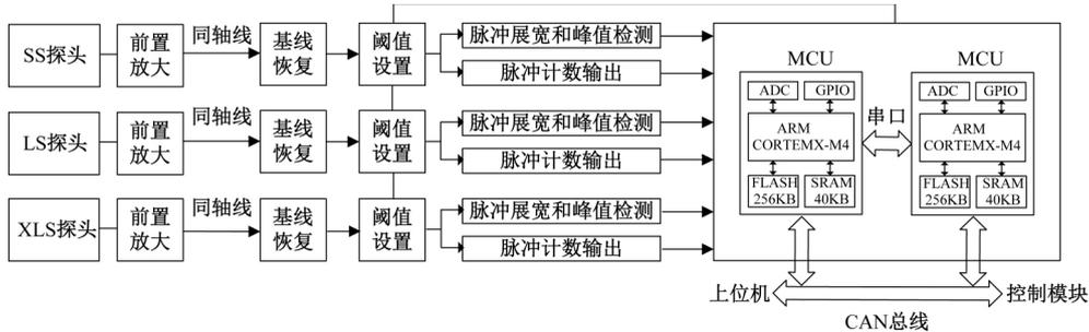
图 2 数据采集电路结构
