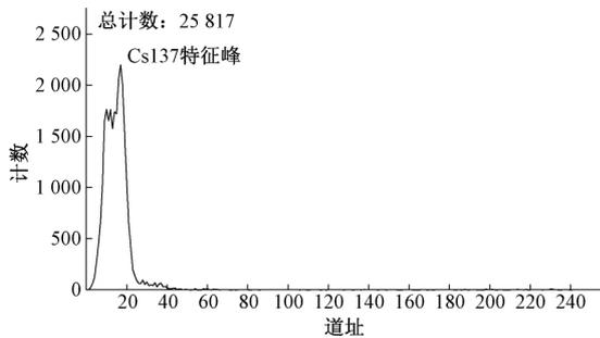
图 9 扣除本底的 Cs137 能谱(10 min 累计)
