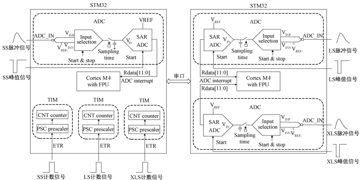
图 4 多路脉冲信号采集电路
