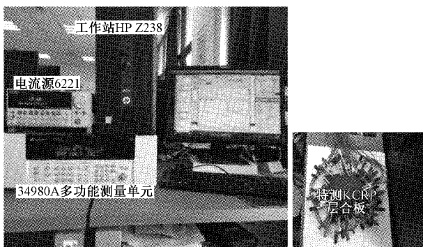
图 8 EIT 硬件测试系统及被测碳纤维层合板
