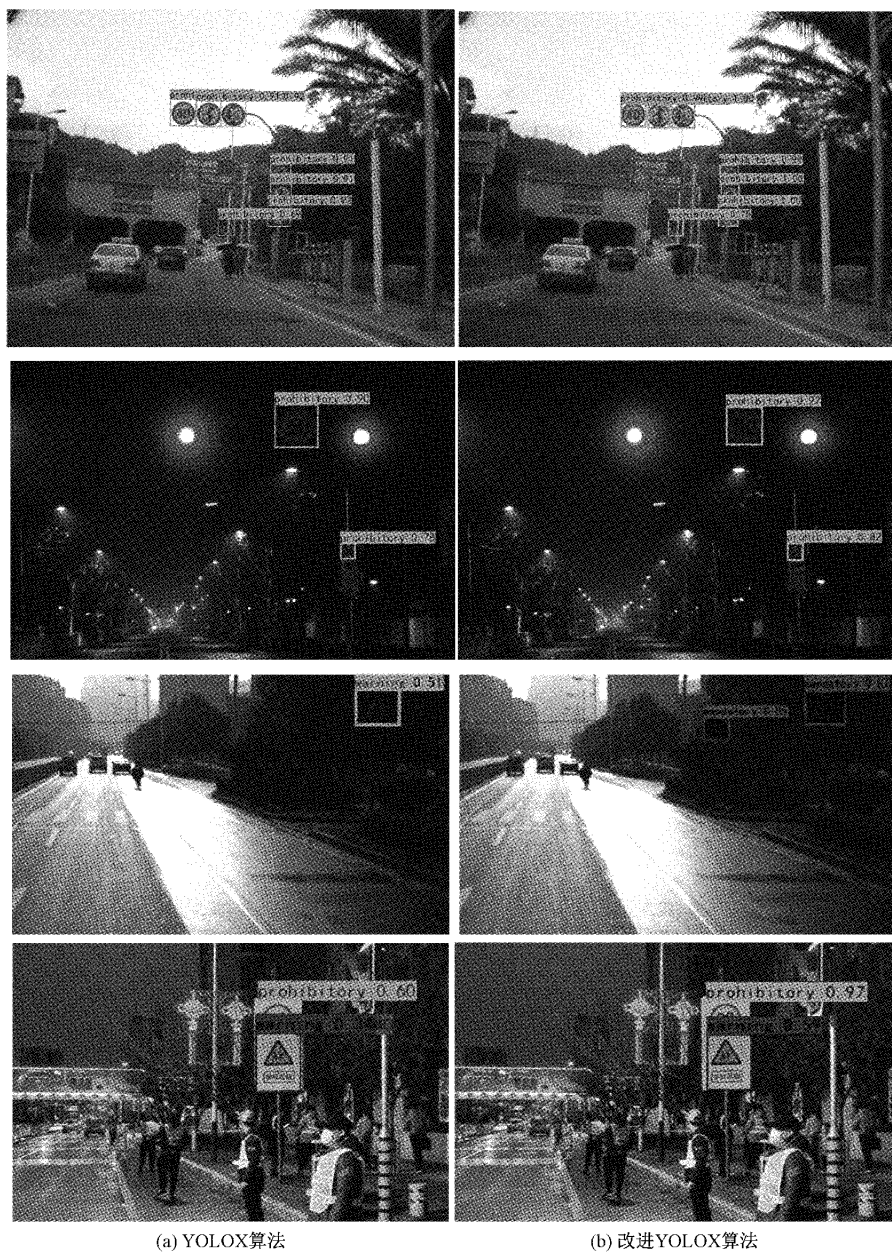
图 3 YOLOX 算法改进前后可视化结果对比
