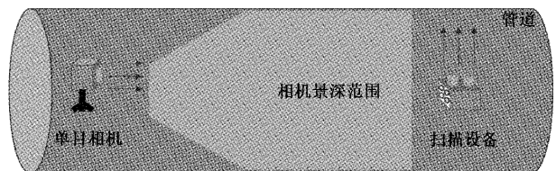
图 2 相机景深限制示意图
