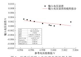
图 7 校准后的输入电压误差线性拟合图 Fig. 7 Linear fit of input voltage error after calibration
