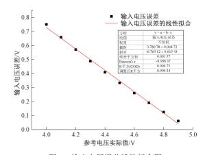
图 6 输入电压误差线性拟合图
