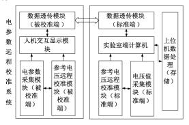
图 1 基于现代通信技术的电参数远程校准系统结构图 Fig. 1 Structure of electrical parameter remote calibration
