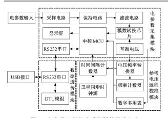
图 3 电参数远程校准系统硬件设计方案
