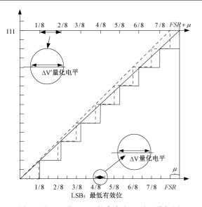
图 4 基于 3 位 ADC 的参考电压误差分析图 Fig. 4 3-bit ADC-based reference voltage error analysis plot
