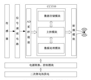
图 3 无线传感节点系统框图
