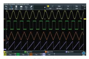
图 7 信号发生器产生波形
