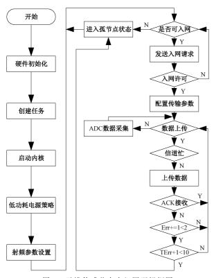
图 5 无线传感节点自组网逻辑框图
