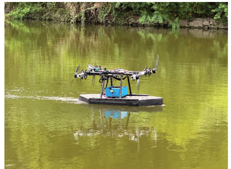
图9 多旋翼空气动力船航行实验图
