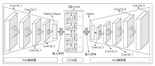
图 5 VAE-LSTM 结构框架图
