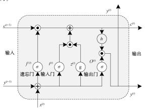
图 2 LSTM 模块结构
