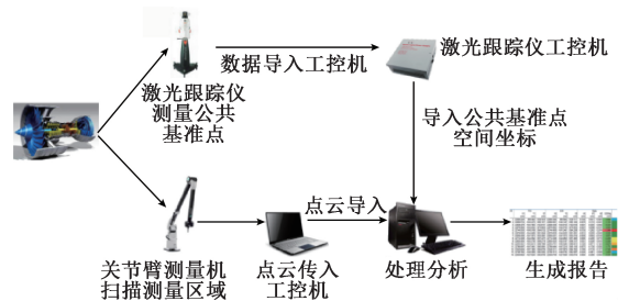
图 1 基于关节臂测量机与激光跟踪仪组合测量系统工作流程
