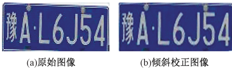
图 8 车牌倾斜校正前后对比
