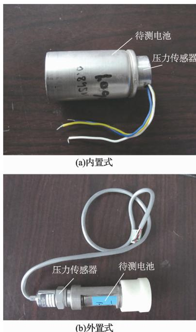
图3 压力传感器与蓄电池封装的两种形式
