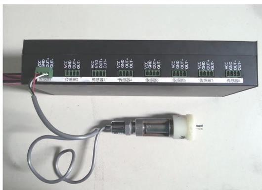
图2 电池内压测试模块及待测电池
