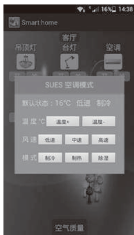
图 10 空调操作界面
