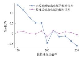
图 12 校准前和校准后输出电压的相对误差
