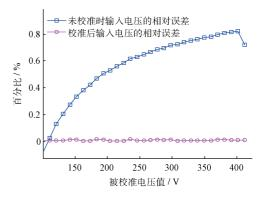
图 8 未校准时和校准后输入电压的相对误差
