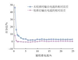
图 14 校准前和校准后输出电流的相对误差
