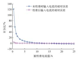
图 10 校准前和校准后输入电流的相对误差
