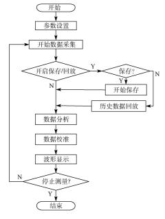
图 6 上位机软件的程序流程
