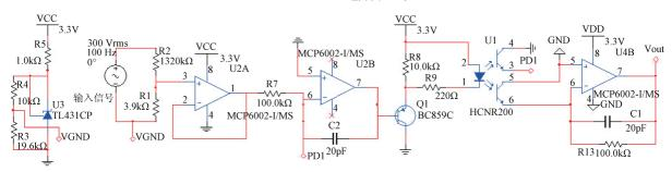
图 2 基于 HCNR200 的隔离电路
