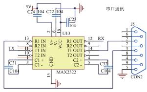
图 4 串口通信电路
