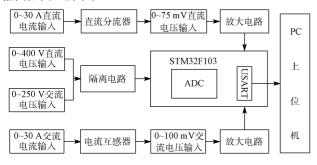
图 1 系统总体结构框图
