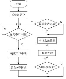
图 5 STM32 单片机软件设计流程图
