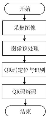
图 2 QR 码解码流程图
