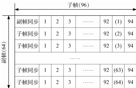
图 1 全帧为 6144 字节的遥测帧格式结构
