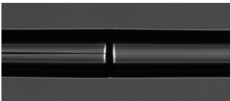
(b) 放电功率为 200\ \text{bit} 的熔接点
