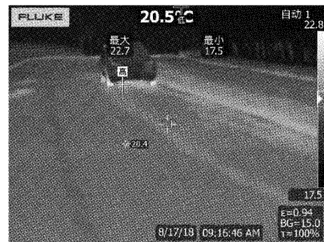
图2 发动机盖与前挡玻璃温度相近
