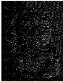
(b) 叠加后的测量条纹的交叉点图像
