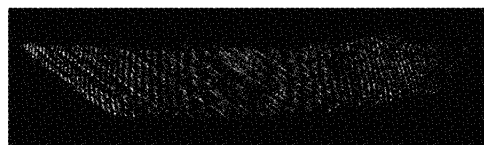
图 14 干涉图像的高频分量二值化后的子图像
