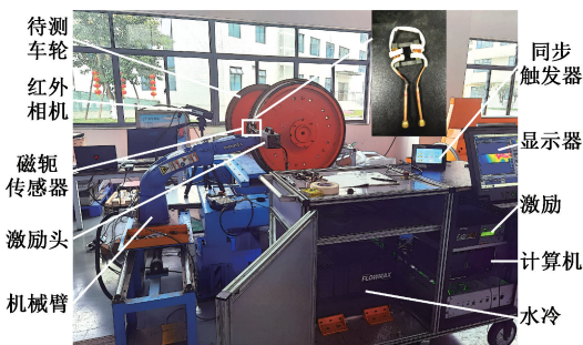
图 8 电磁热成像检测系统实验平台
