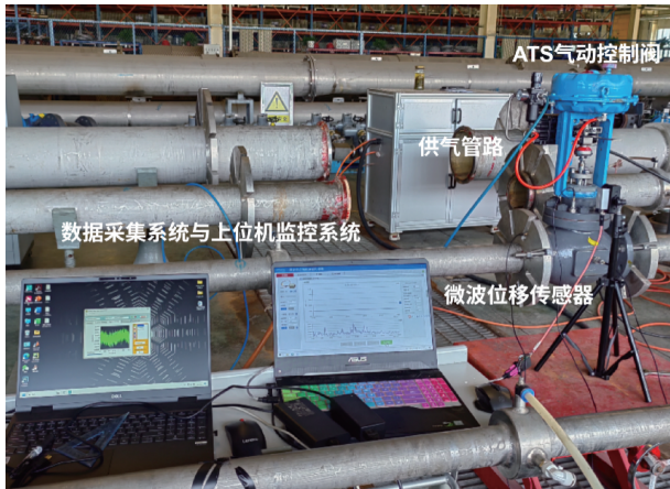
图 9 控制阀故障模拟试验台
